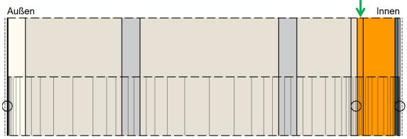
Bild 2.6.2 A Beispiel des kritischen Bereichs (erster Zentimeter der Innendämmung) markiert durch einen grünen Pfeil
