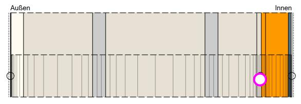
Bild 2.5 A Monitorposition zur Bestimmung der Temperatur und relativen Feuchte hinter der Innendämmung
